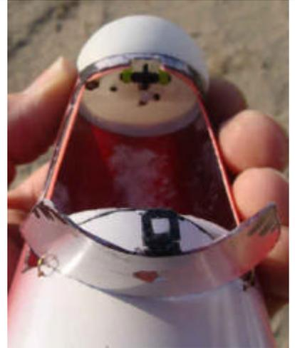
Dans l'ogive, la trappe latérale est découpée. La difficulté essentielle est dans la réalisation de l'articulation. Ici ce sont 2 simples anneaux en laiton (insuffisants pour un bon placage) Voir plus bas pour la version définitive
