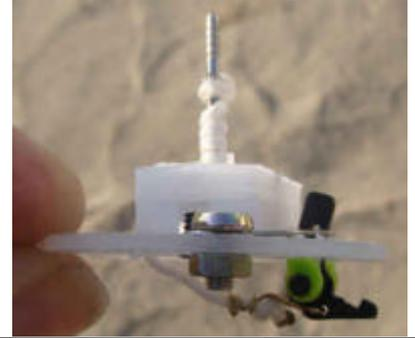
La commande d'ouverture de la trappe se fera par un système TET qui commandera ce petit verrou
