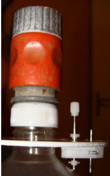
L' ensemble réservoir, disque mécanisme et raccord. Sans le renvoi, ni la cloison supérieure
