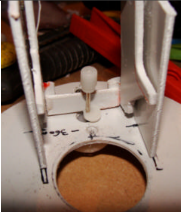
L' ensemble réservoir, disque mécanisme et raccord. Sans le renvoi, ni la cloison supérieure
