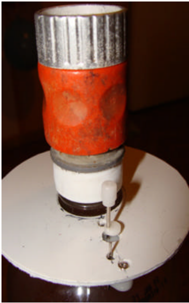
L' ensemble réservoir, disque mécanisme et raccord. Sans le renvoi, ni la cloison supérieure
