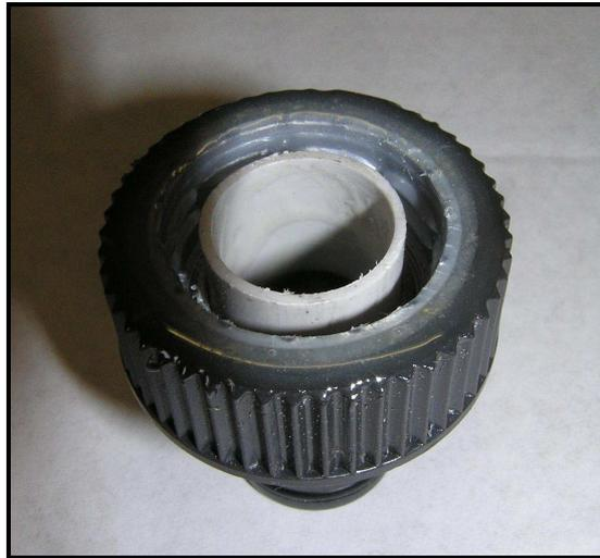
Lorsque la colle a séché, on peut aisément visser la tuyère sur n'importe quelle bouteille ayant le bon diamètre de goulot ; le montage est étanche et résiste très bien à la pression (nous l'avons testé jusqu'à 10 bars).
