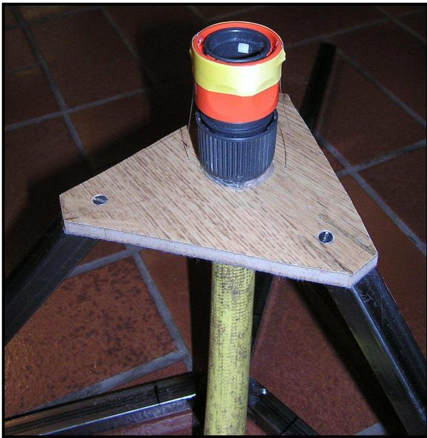
On découpe ensuite la plateforme (elle sera en bois que l'on vernira, n'ayant pas de métal à disposition...), on y colle le connecteur Gardena et les fils de pêche qui permettront au moteur d'abaisser la rondelle. Puis on la visse sur le support métallique.
