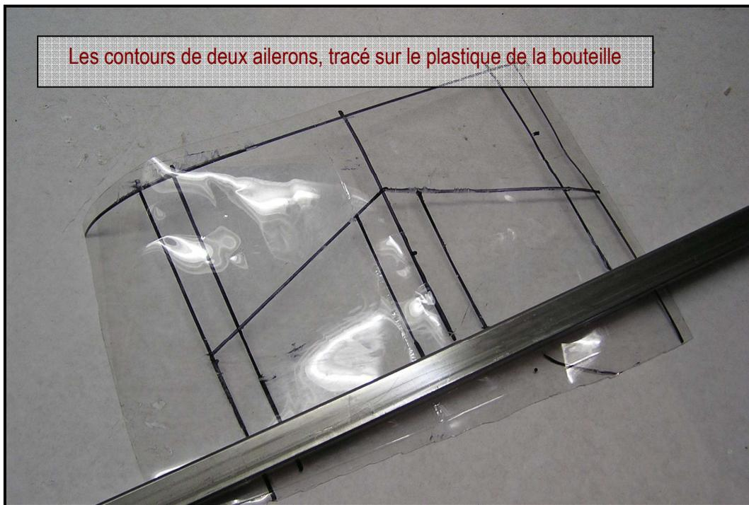
Une fois que l'on a découpé les contours de l'aileron, on applique le ruban adhésif double face sur l'une des faces de l'aileron.
