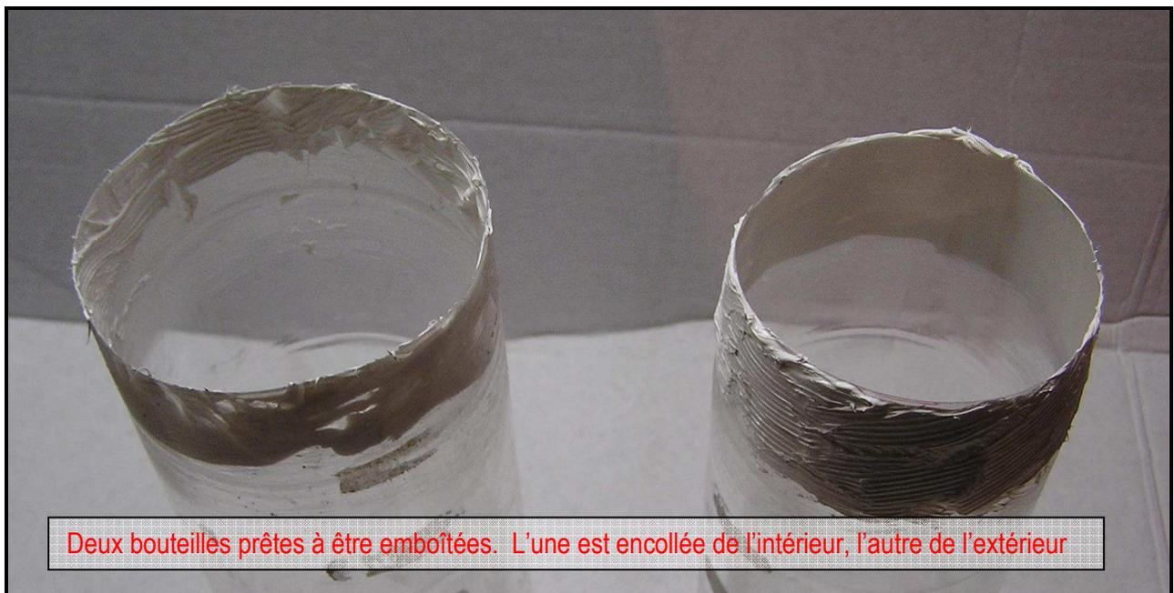
On emboîte les bouteilles au fur et à mesure, en prenant garde à conserver un alignement parfait. Pour cela nous avons mis au point un procédé utilisant un laser, coulé dans un bouchon on le visse sur la bouteille supérieure, ce qui permet de vérifier l'alignement
