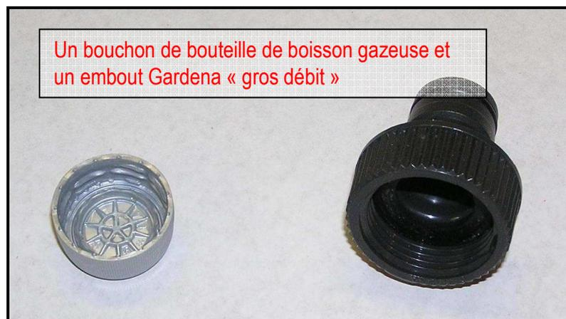
L'embout Gardena assure la jonction avec le pas de tir tandis ce que le bouchon permet de visser l'ensemble sur la bouteille.
