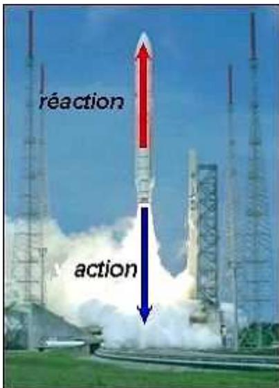
Dans une fusée, de la matière est éjectée à grande vitesse et crée une force dirigée vers le bas (c'est l'action). D'après le principe de l'action et de la réaction, la fusée sera propulsée dans la direction opposée (c'est la réaction).
