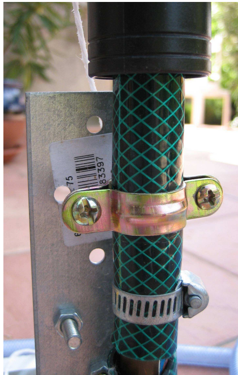
Figure 9 : Système d'étanchéité du raccord « Gardena »
